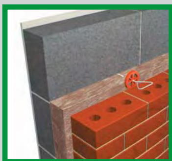
Конструкция слоистой кладки с воздушным зазором между слоем теплоизоляции и облицовочным материалом
