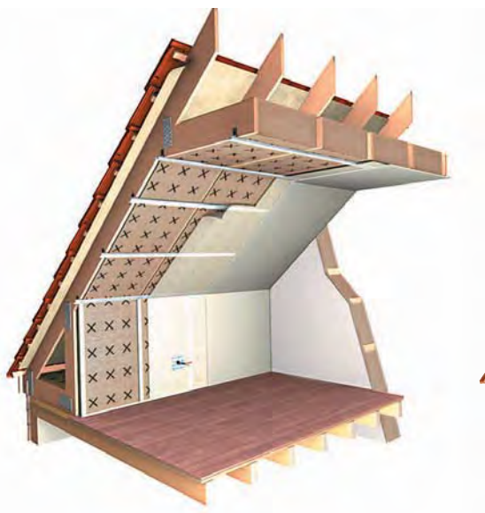
Принцип теплоизоляции мансардного этажа
