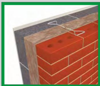
Конструкция слоистой кладки без воздушного зазора
